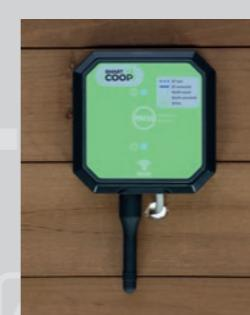
Important : L'antenne pointe vers le bas si l'emplacement choisi pour le montage est correct. Veiller surtout à ne pas installer le module à l'envers, faute de quoi son étanchéité ne serait pas garantie !
