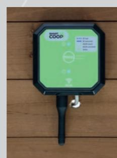
Wichtig: In korrekter Einbausituation zeigt die Antenne nach unten. Das Modul darf keinesfalls verkehrt herum montiert werden, da sonst keine Dichtigkeit gewährleistet wird!
