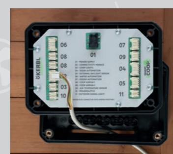
Important : Pour des raisons techniques, il est interdit de rallonger le câble de connexion du module de connectivité !
