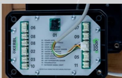
Si la longueur de câble de connexion raccordé au module n'est pas suffisante, servez-vous d'une rallonge (Réf. 70633, 70634). Veuillez à la protection du point de connexion contre l'eau et la poussière ! Un rallongement du câble n'est admissible qu'une seule fois.
